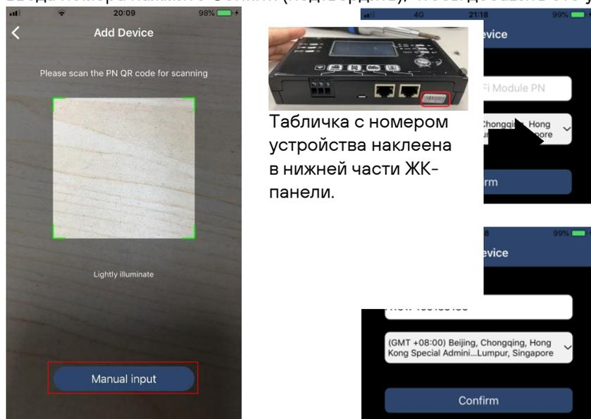
Табличка с номером устройства наклеена в нижней части ЖК-панели.
