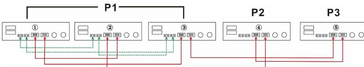
Два инвертора на одной фазе и только один инвертор на оставшейся фазе
