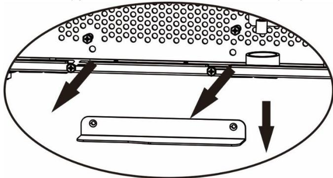
**Шаг 4.** Установите новую плату параллельного режима и надежно закрепите двумя винтами.
