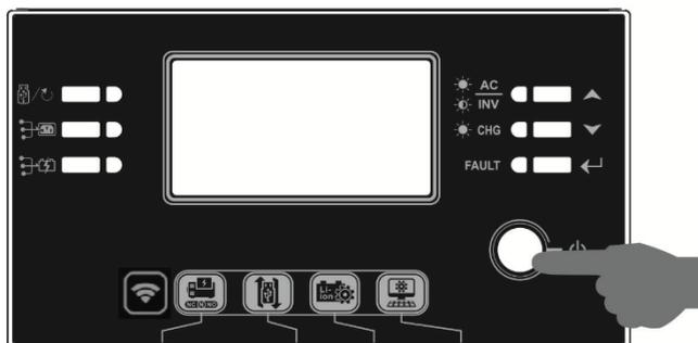
После правильной установки устройства и надежного подключения аккумуляторных батарей нажмите кнопку включения/выключения, чтобы включить устройство.
