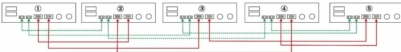
Шесть параллельных инверторов
