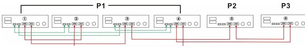
Три инвертора на первой фазе, два инвертора на второй фазе и один инвертор на третьей фазе
