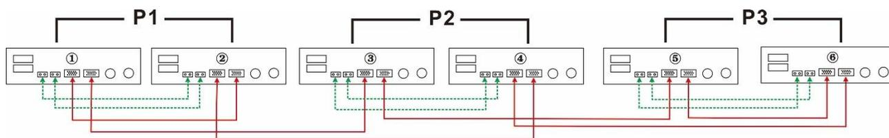
Четыре инвертора на одной фазе и один инвертор для двух других фаз
