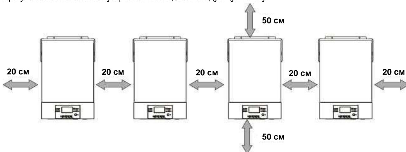
**Примечание.** Для правильной циркуляции воздуха и отвода тепла обеспечьте свободное пространство около 20 см по бокам и около 50 см над и под устройством. Обязательно устанавливайте каждое устройство на одном уровне.
