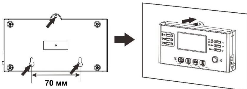
**Примечание.** Крепление к стене должно выполняться соответствующими винтами. См. таблицу с рекомендуемыми характеристиками винтов.
