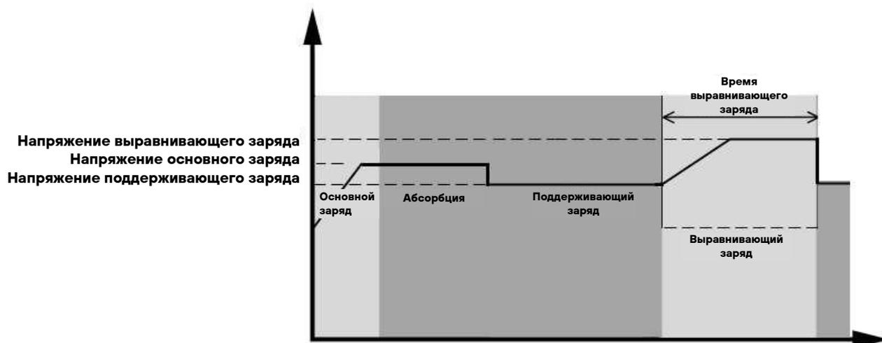
Тем не менее, если на этапе выравнивания напряжение на батарее не успело достигнуть напряжения выравнивающего заряда за установленное время, выравнивающий заряд будет продлен, но не далее времени установленного тайм-аута. Таким образом, если напряжение батареи все еще ниже, чем напряжение выравнивающего заряда, а время тайм-аута уже истекло, контроллер заряда остановит выравнивающий заряд и вернется к режиму поддерживающего заряда.
