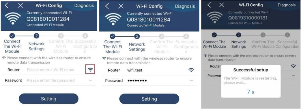
**Шаг 4.** Нажмите Confirm (подтвердить), чтобы завершить настройку подключения Wi-Fi между модулем Wi-Fi и интернетом.
