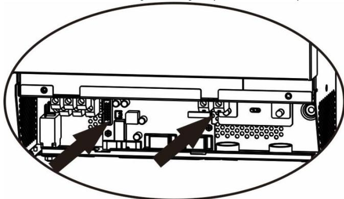
**Шаг 5.** Подключите снова 2-контактные и 14-контактные разъемы к плате параллельного режима, как показано на рисунке ниже.
