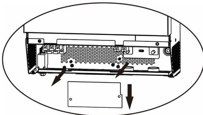
**Шаг 3.** Открутите два винта, как показано на рисунке ниже, и снимите крышку модуля параллельной связи.
