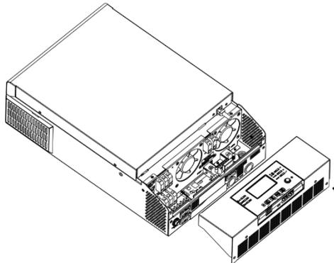
**Шаг 2.** Открутите два винта, как показано на рисунке ниже, и отключите 2-контактный и 14-контактный кабели.
